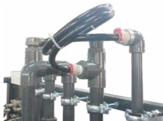
Встановлений та підключений вузол (показано для MO-1...MO-9)
