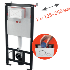
AM101/1120 Sádromodul Прихована система інсталяції для сухої установки (для гіпсокартону)
