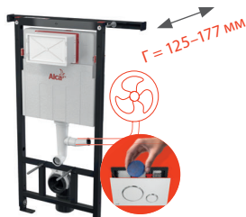
AM102/1120V Jádromodul Прихована система інсталяції з можливістю вентиляції для сухої установки (при реконструкції ванних кімнат в панельних будинках)
