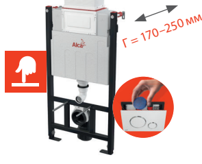
AM118/1000 Sádromodul Прихована система інсталяції для сухої установки (для гіпсокартону), управління зверху або спереду
